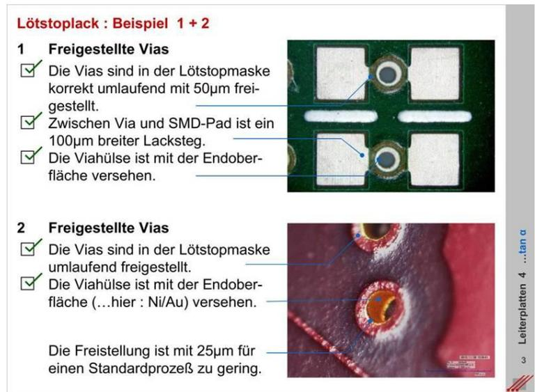
Bild 21-3 Geometrische Spezifikation für den Lötstopplack
