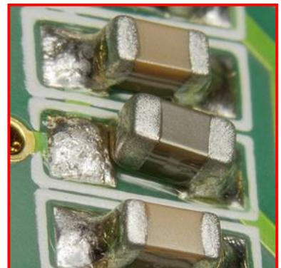
Bild 7.2-3 Offene Lötstellen
