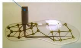
Matrix mit Drucksensoren
