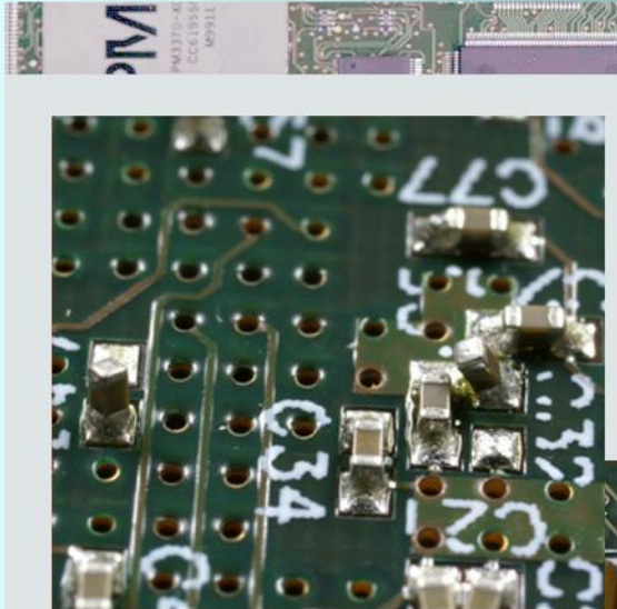
Tombstoning/Vias in Pads Lotabfluss durch Vias
