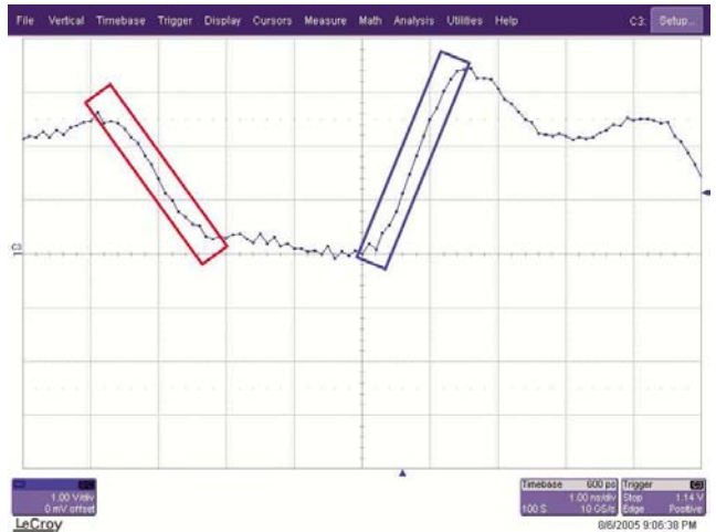
Bild 4: Die FPGA-Datenleitung DQ23 im DCI-(Automatik-)Mode mit 1 ns/Teilung, ebenso höher aufgelöst. Die Anstiegszeiten (blau) und Abfallzeiten (rot) unterscheiden sich erheblich.
