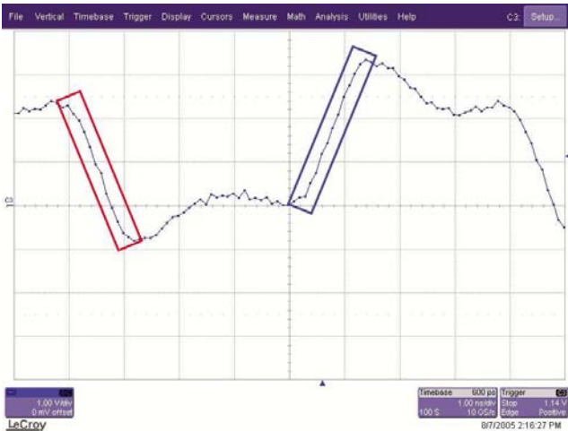
Bild 3: FPGA-Datenleitung DQ23 im 24-mA-Fast-Mode mit 1 ns/Teilung, also höher aufgelöst. Die Anstiegszeiten (blau) und die Abfallzeiten (rot) sind nahezu identisch.
