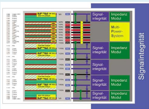
Für die hohe Integrität der Signale ist ein Übersprechen zwischen benachbarten Signalleitungen soweit wie möglich zu reduzieren
