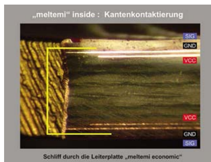
Bild 2: Links ist im Anschnitt die Kante der Leiterplatte zu sehen (chemisch Gold auf Kupfer). Die GND-Lagen 2 und 5 gehen bis an den Rand der Leiterplatte und werden über die Leiterplattenkante elektrisch miteinander verbunden.
