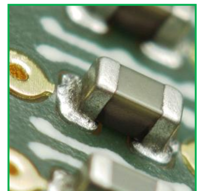
Bild 7.2-5 Gegen Tombstoning und Verdrehen bzw. Lötfehler optimierte Anschlußflächen für die Bauform I0402/M1005 ("I" ~ Inch, "M" ~ Metrisch)
