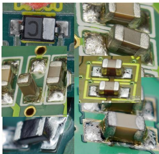
Bild 7.1-3 Verschiedene Lötfehler durch zu große Anschlußflächen beim Reflowlöten
