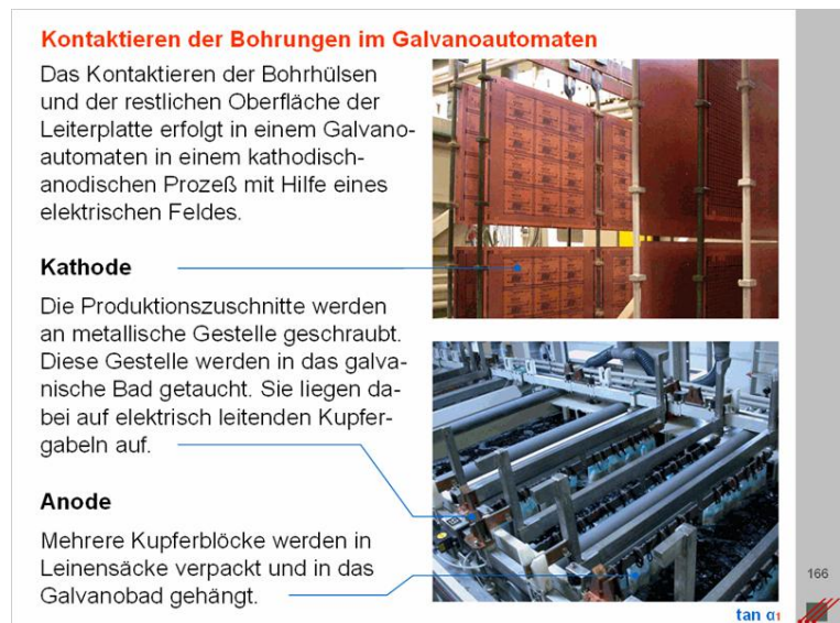
Bild 5-1 Galvanotechnisches Metallisieren
