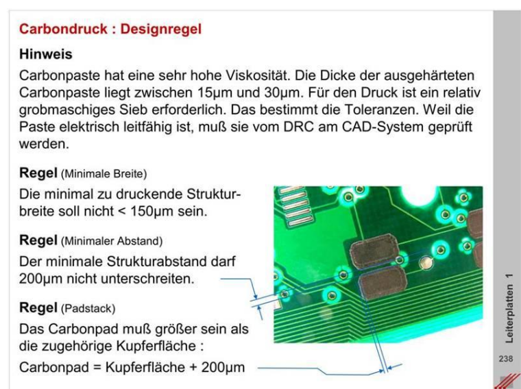
Bild 15-5 Carbondruck auf den Kontaktflächen einer Leiterplatte
