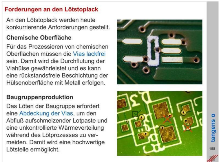
Bild 15-1 Anforderungen an Lötstoplack auf Leiterplatten
