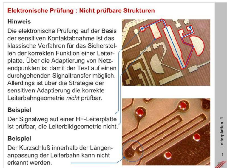
Bild 18-2 Elektrisch nicht prüfbare Strukturen
