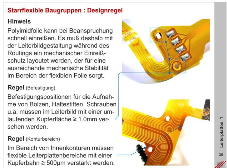
Bild 14-2 Einfache Designregeln für flexible Bereiche
