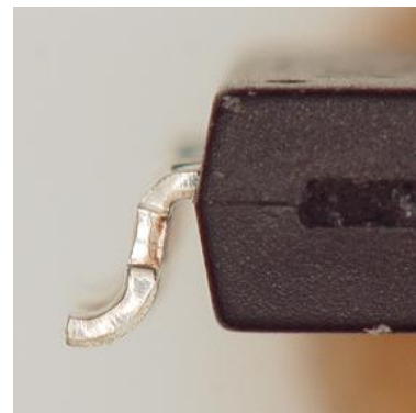
S-förmiger Anschluß (z.B. S/SO/SOT/QFP mit RM1.27-0.4mm)
