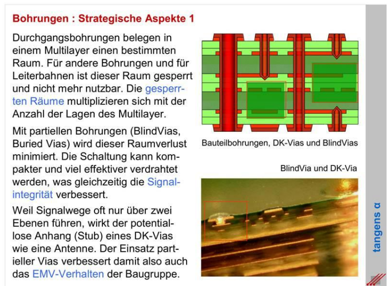
Bild 10-2 Multilayer mit Innenliegenden Kernen und mit BlindVias
