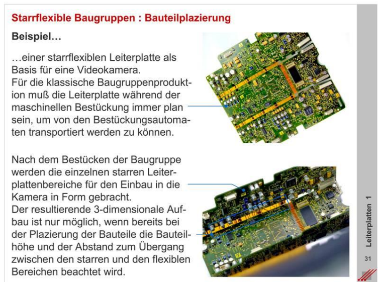
Bild 14-3 Bauteilplatzierung und Baugruppenmontage
