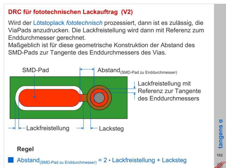
Bild 12-2 Designregel für fotosensitiven Lötstoplack
