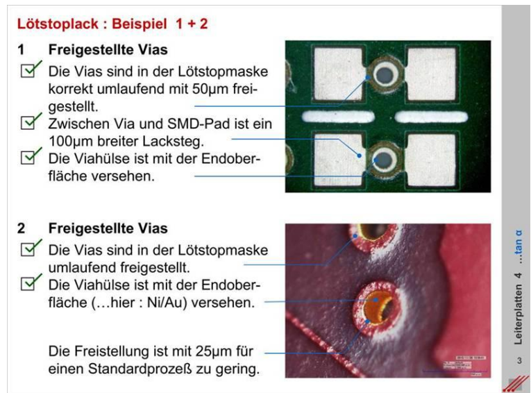
Bild 21-3 Geometrische Spezifikation für den Lötstoplack
