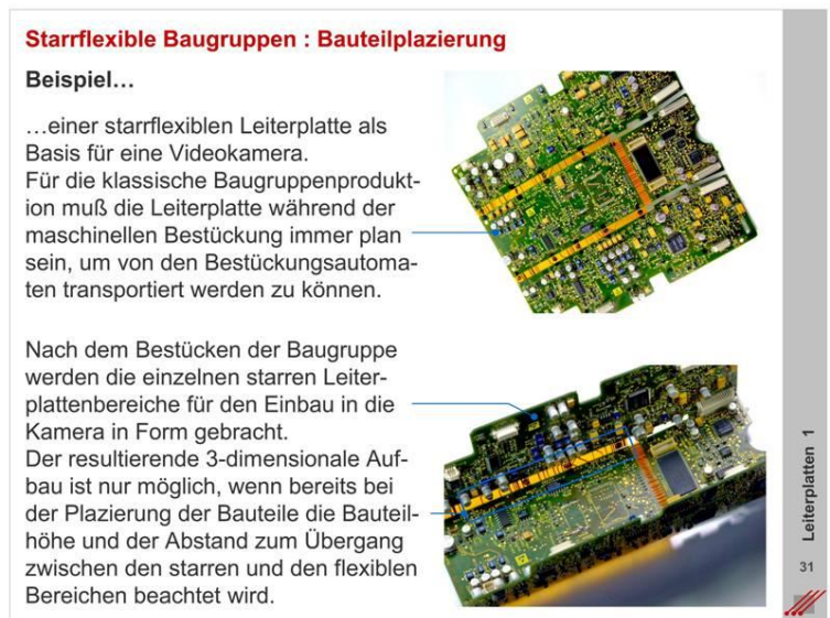
Bild 14-3 Bauteilplatzierung und Baugruppenmontage
