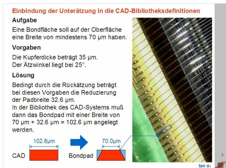
Bild 8-3 Berechnung von Bondflächen für die Bauteilanlage in der CAD-Bibliothek
